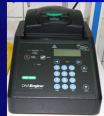
Współczesny model z gradientem temperaturowym i grzejną pokrywą.
